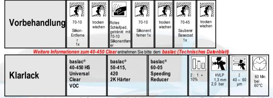
Hinweis: Nach dem ersten Auftragen des Klarlacks können sichtbare Oberflächenfehler (z.B. Nadellöcher) manuell mit einem Pinsel befüllt werden. Nach dem Zwischenschleifen mit einem Orbitalschleifer (P400 – P600) oder nach dem manuellen Schleifen (P800 – P1000) kann dieser Schritt wiederholt werden, bis das gewünschte Ergebnis erreicht ist.
